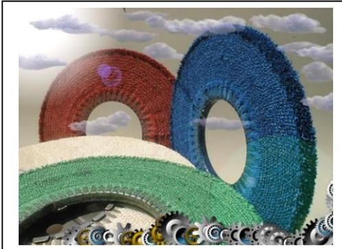
Il TIPO **LRS/6 SISAL** è una tipica ruota di sgrossatura che utilizza come materiale tessile un tessuto di fibra vegetale denominato “**SISAL**”, tale materiale è noto per l’elevata capacità abrasiva e per la buona igroscopicità, tanto da permettere un corretto impiego in operazioni preliminari di pulitura sia con paste abrasive liquide che solide.
